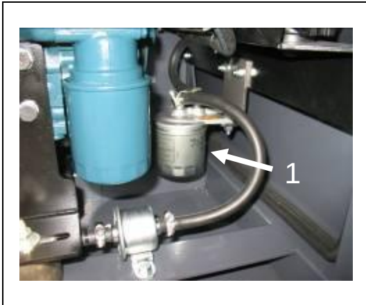
(1) Kraftstofffiltertopf. Fuel filter pot.
